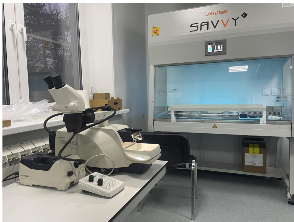
Рисунок 1. Полуавтоматический микротом с вибрирующим лезвием Leica VT1200 в лаборатории отделения регенеративных технологий и биофабрикации МРНЦ им. А.Ф. Цыба – филиала ФГБУ «НМИЦ радиологии»
